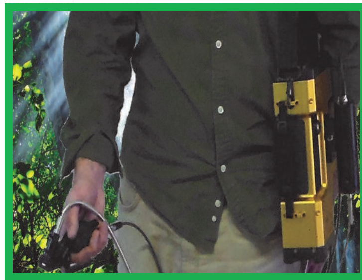
Спектрорадиометр PSR+ может быть использован в сочетании с FOV линзой (опция) на 4,8 или 14° устанавливаемыми непосредственно на спектро-радиометр, или с оптоволоком 25°, диффузором и интегрирующей сферой.
